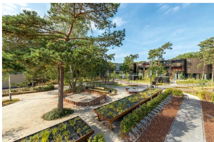
Een hotspot in de wijk is het zogenoemde energieplein nabij het Christelijk College Zeist. Hier worden allerlei innovatieve technische snufjes uitgetoetst die wereldwijd uniek zijn. Bijvoorbeeld de plantbatterijen van Plant-e: in verhoogde bakken (100 m 2 ) wekken waterplanten stroom op. Ook is een pannaveld aangelegd met tegels van Energy Floors, door beweging wekken ook deze stroom op.
