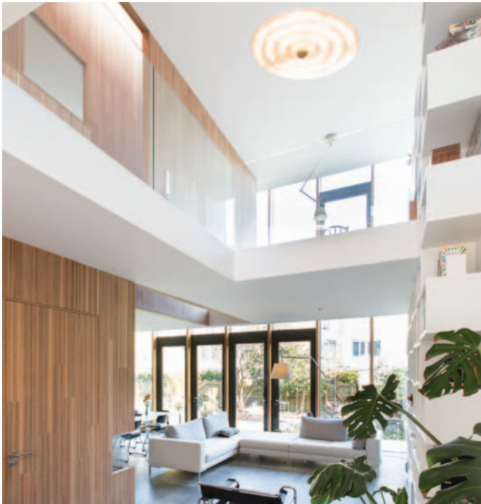
DE TRAPPEN, WANDEN EN DEUREN BESTAAN UIT GELAMINEERD MERANTI
