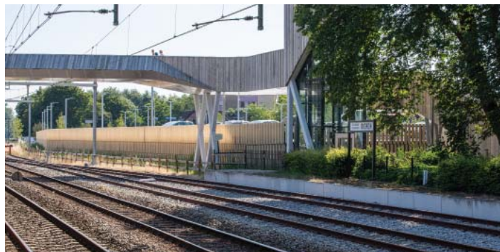
LAMELLEN GEVEN DE GEVEL DE BENODIGDE GELAAGDHEID, TRANSPARANTIE EN VENTILATIEMOGELIJKHEDEN
